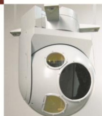
航空光电平台 Airborne Optoelectronic Platform
